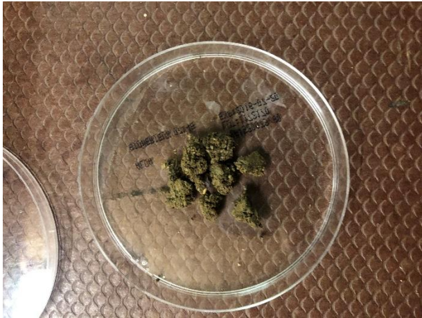
Abb.18, Gefüge und Aggregatstabilitätsnachweis in Petrischale [Foto: Julian Voracek]
